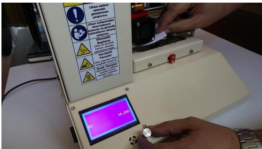
Yazılım destekli tabla seviyeleme ayarı yapıldıktan sonra topografiyanın değişmemesi için tabla seviyeleme vidalarının konumu ile oynamayınız. Baskı yüzeyini yerinden çıkardığınızda yine aynı yüzü üstüne baskı alacak şekilde aynı yönde geri yerleştirmeye özen gösteriniz. Aksi takdirde topoğrafya değişeceği için ayarı tekrar yapmanız gerekecektir.
