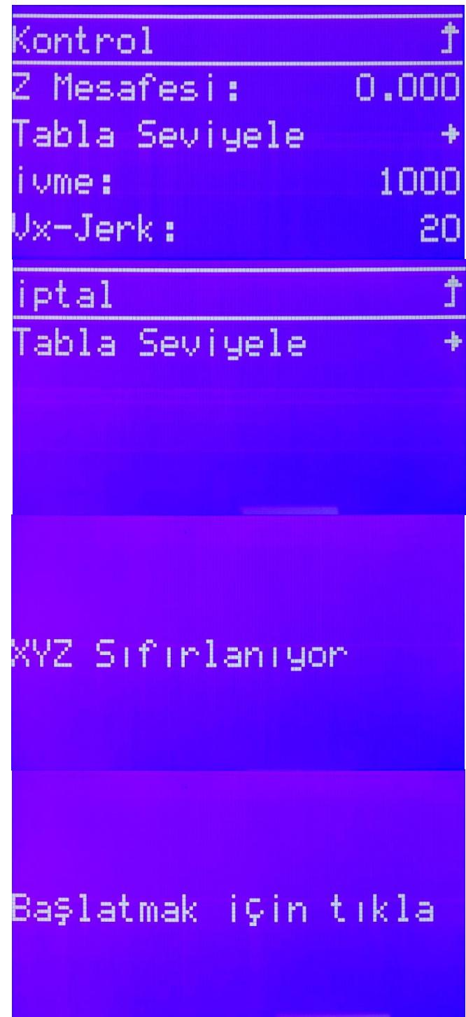
6. Yaptığınız ayarın cihaz kapatıldığında silinmemesi için Kontrol->Hafızaya Al komutu ile değerlerin cihaz hafızasına yazılmasını sağlayınız.
