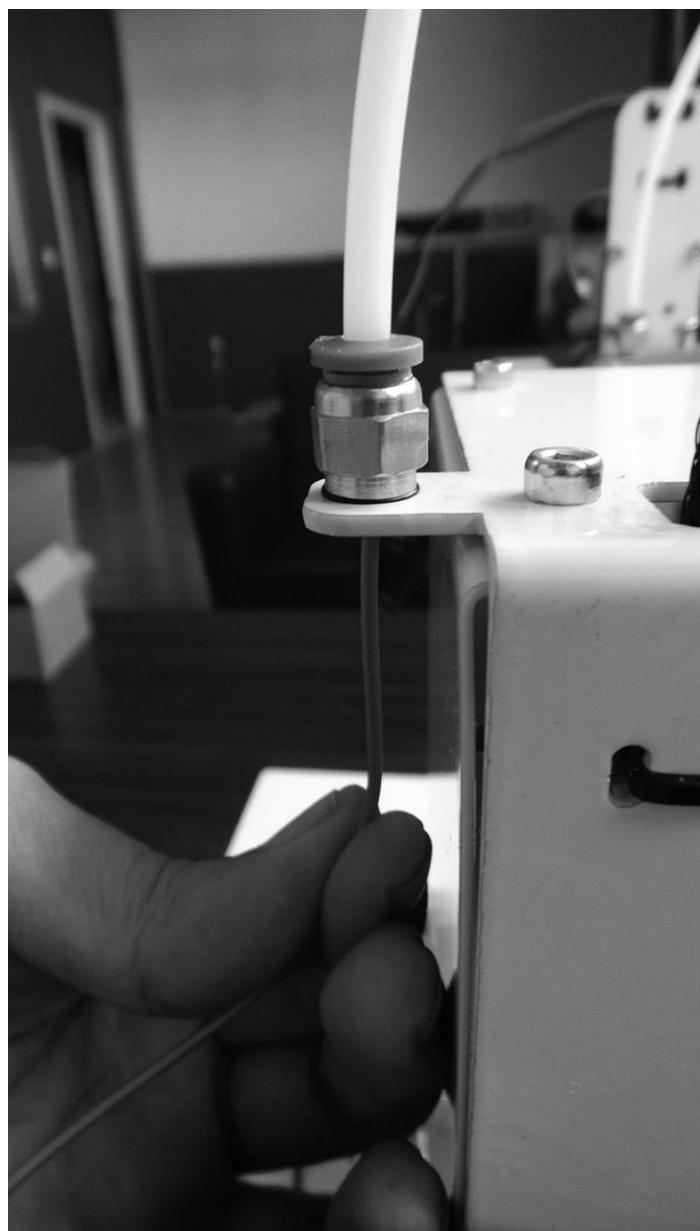
4. Filamanın ucunu filaman kılavuz hortumunun içinden iterek ekstrudere ularsınız.
