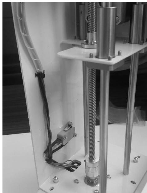
Soldaki resimde görüldüğü şekilde dikdörtgen şeklindeki açıklıktan kabloları alt gövdeye geçiriniz.
